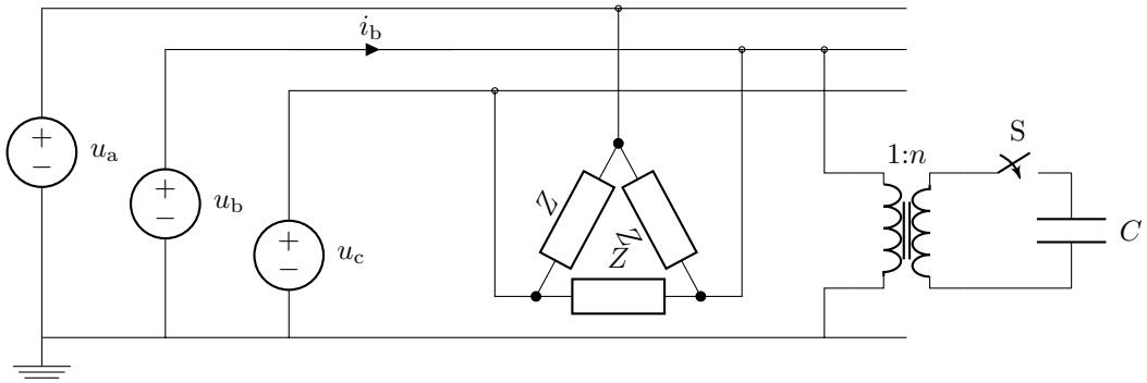
Diagrammet ovan visar en ideal trefas spänningsskälla vilken försörjer en symmetrisk last och en asymmetrisk last. Källan har vinkel-frekvensen  $\omega$ ; absolutbeloppet av fasspänningen är  $U_p$  (effektivvärde), och fasföljden är  $abc$ . Vi räknar helt i frekvensdomänen, med  $u_a$  som referensfas ( $0^\circ$ ), och i effektivvärdeskalan. Därför är till exempel visaren för spänningen mellan fas-c och noll-ledaren  $u_c(\omega) = U_p / -4\pi/3$  (eller, ekvivalent,  $U_p / 2\pi/3$ ).
