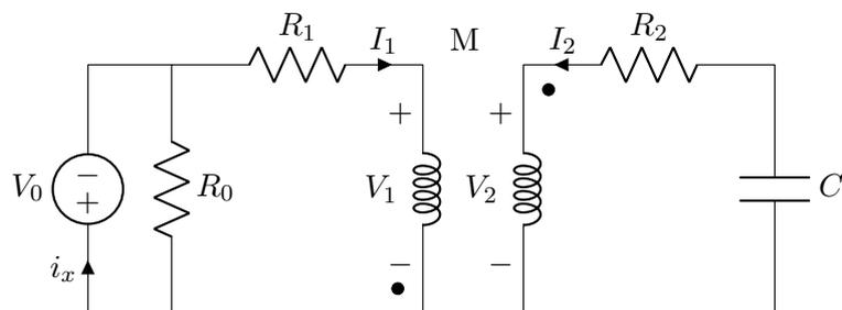
Vi definierar strömmarna  $I_1$  och  $I_2$  på primär- och sekundärsidan som ger upphov till spänningsfall som följer dem enligt passiv teckenkonvention. Vi får motverkande flöden pga hur strömmarna flyter in i prickarna. Vi definierar även en ström,  $i_x$ , som flyter upp genom  $V_0$ .
