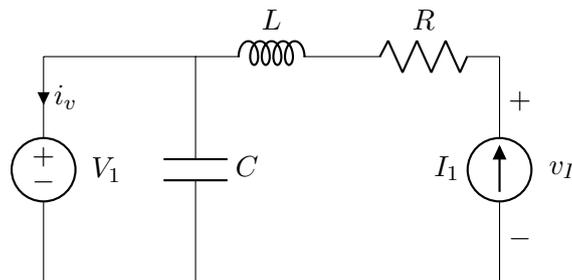
Vi definierar strömmen  $i_v$  som går ner genom  $V_1$  samt ett spänningsfall  $v_I$  över  $I_1$  med plus polen högst upp. Använder toppvärdesskalan för de komplexa effekterna.
